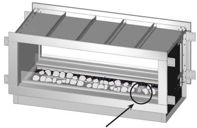
ENSURE NO ROCK IS PLACED ON THE IGNITION PORTION OF THE BURNER, DIFFICULTIES IN LIGHTING MAY RESULT.
